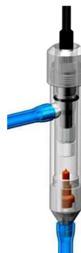
Рис. 3.1. Внешний вид амперометрических сенсоров АСрН 2 -03 и АСрН 2 -04
