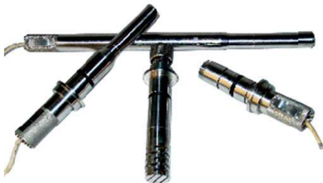
Рис. 3.3. Внешний вид стерилизуемых амперометрических сенсоров АСрН 2 -06
